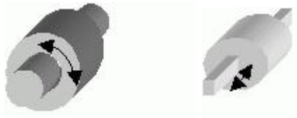
Rysunek 8. Przykłady połączeń klasyfikowanych jako węzły niższe.
